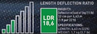
**GLAS FASER:** Glasfaser mit hoher Steifigkeit und maximalem Arbeitskomfort. Empfohlen für Arbeitshöhen von bis zu 10 m. Endfestigkeit des Materials: 47 GPa\*
